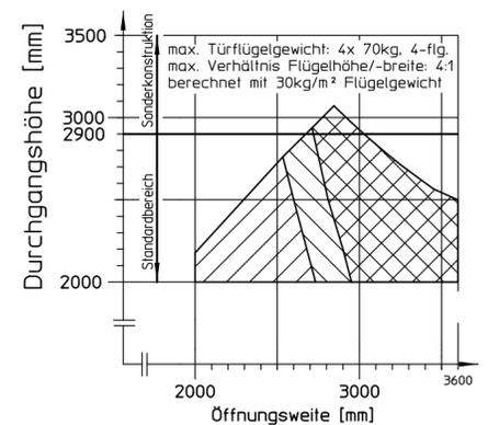
Das Diagramm ist nur gültig, wenn 4-flügelige Antriebe an 4 Pfosten befestigt werden.
