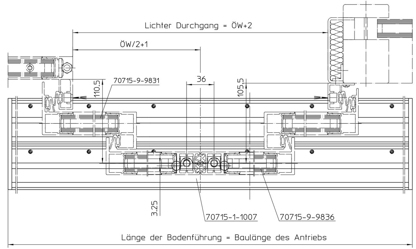
Linke Darstellung für freitragenden Träger. Freitragender Träger mit ESG sinngemäß. Rechte Seite spiegelbildlich.
