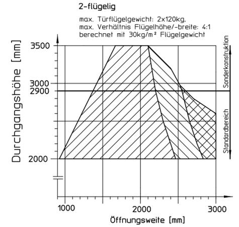
Das Diagramm ist nur gültig, wenn 2-flügelige Antriebe an 4 Pfosten befestigt werden.
